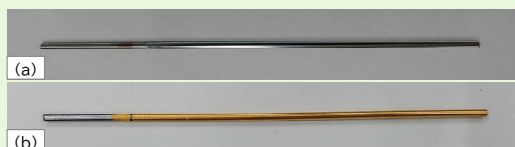
図2 クロムおよび金めっきディスクヨーク素材 (a)クロムめっき、(b)金めっき
