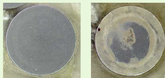
試験開始前 約270万回後 図7 咬合試験前後の吸着面状態
